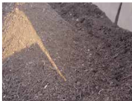
図18 釜石市の仮置場で分別された20 mm以下の災害廃棄物 (2012.3.14撮影)
