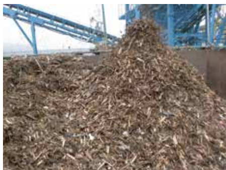
図21 破碎、篩い分けされた可燃物
