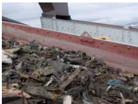
図9 粗破碎された混合廃棄物
