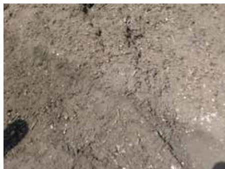
図13 洗浄前の可燃物などを含む細粒分
