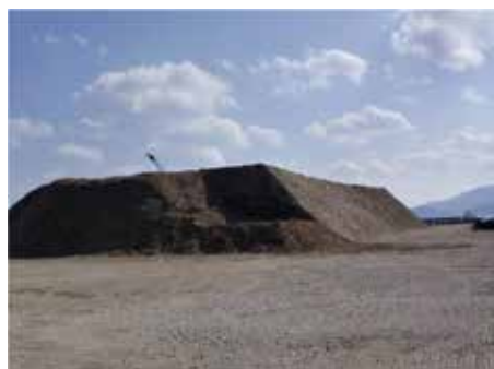
図10 破碎、選別後の可燃物チップの在庫（2012.3.15撮影）
