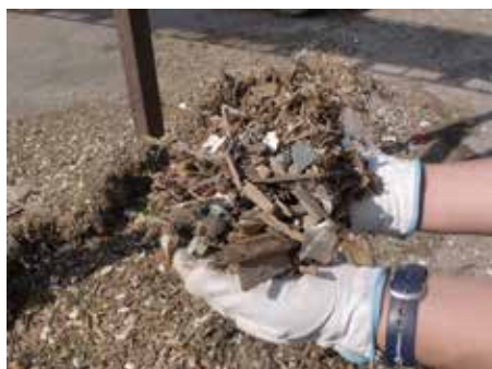
図11 洗浄によって分離された可燃物
